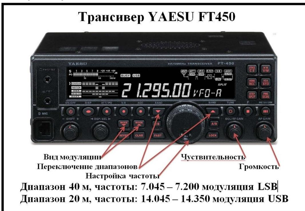
Рис. 4. Передняя панель радиоприемника.
